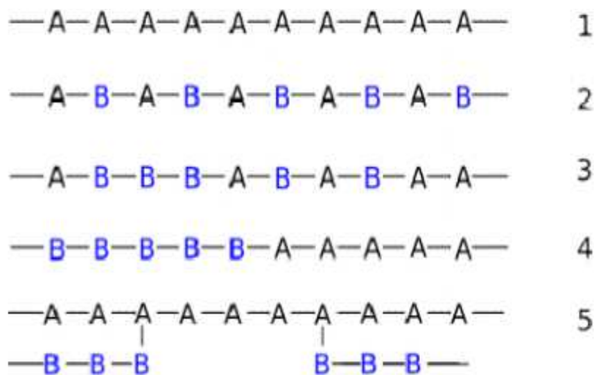
Σχήμα 1.5: Διάφορες κατηγορίες πολυμερών βάση της χημικής δομής. Το (1) αντιστοιχεί σε ομοπολυμερές, ενώ τα (2) έως και (5) σε συμπολυμερή. Ειδικότερα το (2) δείχνει τη δομή ενός εναλλασσόμενου, το (3) ενός τυχαίου, το (4) ενός αδρομερούς και το (5) ενός ενοφθαλμισμένου πολυμερούς.
