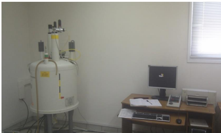
Σχήμα 2.8: Φωτογραφία του μαγνήτη για την λήψη φασμάτων NMR.
