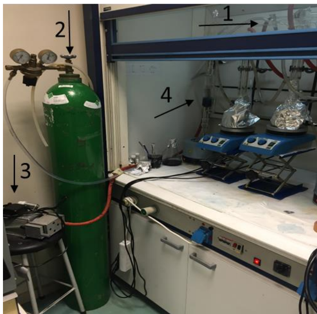
Σχήμα 3.7: Πειραματικές διατάξεις για τη σύνθεση και καθαρισμό των συζυγιακών πολυμερών, όπου παρατηρείται: (1) γυάλινο σύστημα αργού/κενού μέσα στον απαγωγό, (2) φιάλη αργού παροχής της αδρανούς ατμόσφαιρας, για τη πραγματοποίηση των πολυμερισμών, (3) αντλία κενού και (4) διάταξη καθαρισμού των πολυμερών με εκχύλιση Soxhlet.
