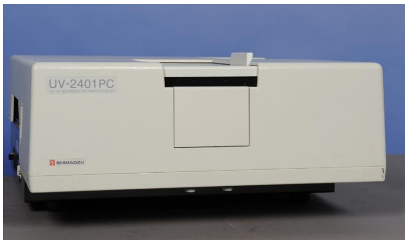
Σχήμα 2.13: Φασματοφωτόμετρο της εταιρίας Shimadzu τύπου GX Shimadzu 2401 που χρησιμοποιήθηκε στα πλαίσια της παρούσας εργασίας.
