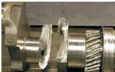
Εικόνα 2: Παραδείγματα αστοχιών δομικών κατασκευών και μηχανολογικών στοιχείων λόγω κόπωσης. 3,4
