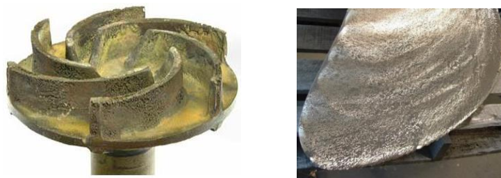
Εικόνα 15: Χαρακτηριστικά παραδείγματα μηχανικών στοιχείων τα οποία έχουν υποστεί σπηλαιώδη διάβρωση. 35,36
