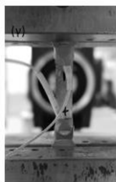
Εικόνα 46: Πειραματική διάταξη προσδιορισμού του ορίου διαρκούς αντοχής, (α) πειραματική διάταξη, (β) επιφάνεια δοκιμίου με επικάλυψη και (γ) πίσω πλευρά δοκιμίου στήριξης των αισθητήρων ΑΕ.
