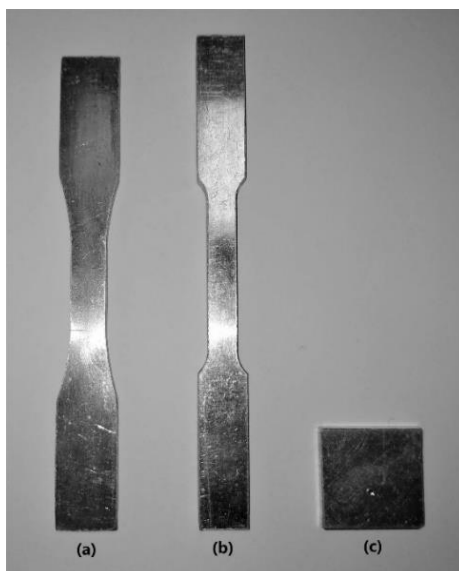
Εικόνα 36: Παρουσίαση των διαθέσιμων ειδών δοκιμίων αλουμινίου 7075, όπου (a) δοκίμιο εφελκυσμού, (b) δοκίμιο κόπωσης και (c) τετράγωνα δοκίμια.
