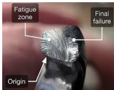
Εικόνα 3: Χαρακτηριστικές επιφάνειες, σε μακροσκοπικό και μικροσκοπικό επίπεδο, αστοχίας δοκιμίου τιτανίου Ti-6Al-4V λόγω κόπωσης. 5,6
