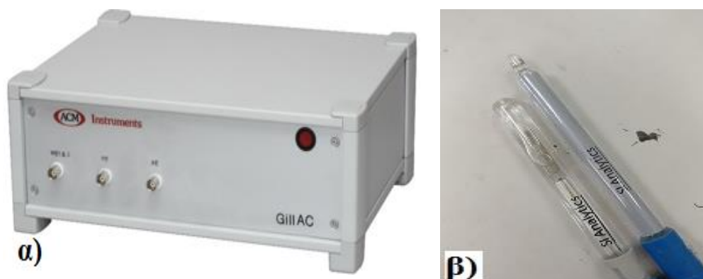
Εικόνα 6.9: α) Ο γαλβανοστάτης Gill AC της εταιρείας ACM Instruments, β) τα ηλεκτρόδια χλωριούχου αργύρου (διάφανο) και πλατίνας (γκρι) που χρησιμοποιήθηκαν στις δοκιμές διάβρωσης.
