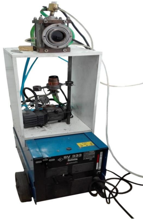
Εικόνα 6.2: Η διάταξη τήξης τόξου σε περιβάλλον κενού (VAM) του εργαστηρίου Εφαρμοσμένης Μεταλλουργίας.
