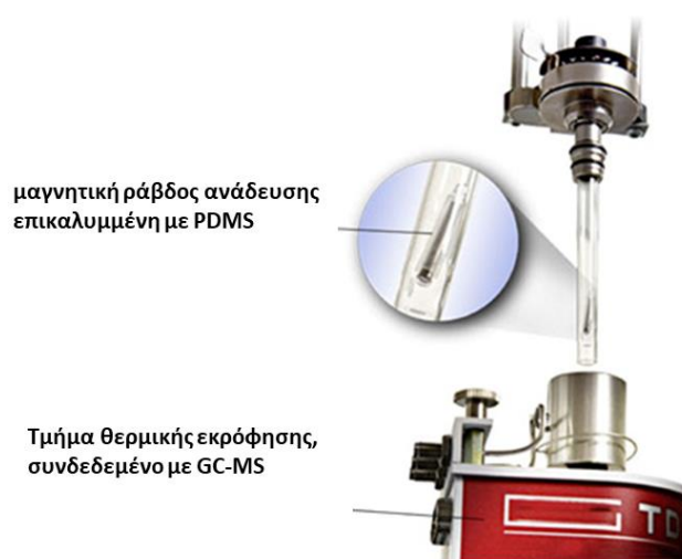
Σχήμα 3.5 Πειραματική πορεία SBSE συζευγμένης με GC-MS
