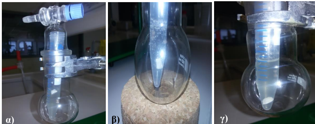
Εικόνα 7.2 α) Τοποθέτηση ικρίωματος στο υδροπήκτωμα, β) μετά από απαέρωση και γ) διείσδυση υδροπηκτώματος στο ικρίωμα.
