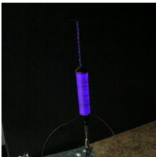
Εικόνα 4. Εκκένωση κορόνας γύρω από ένα πηνίο υψηλής τάσης.
