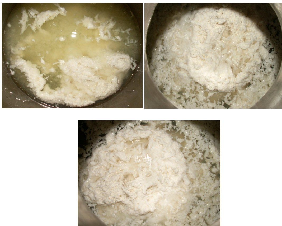
Σχήμα 4.11. Καταβύθιση κεφίρανης με αιθανόλη σε τρία στάδια.
