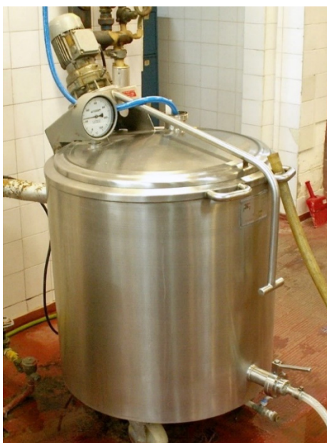
Σχήμα 4.7. Διπλότοιχη ανοξείδωτη δεξαμενή με μηχανικό αναδευτήρα που χρησιμοποιήθηκε για τη θέρμανση και τη διάσπαση των κόκκων κεφίρ.
