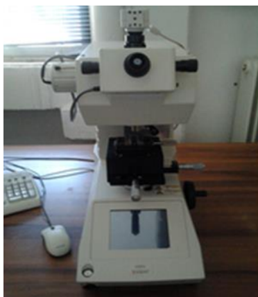
Εικόνα 3.7: Μικρο-σκληρόμετρο Εργαστηρίου Μεταλλουργίας της Shimadzu HV
