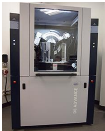
Εικόνα 3.11: Συσκευή περίθλασης ακτίνων-χ της εταιρίας Bruker D8 Advance
