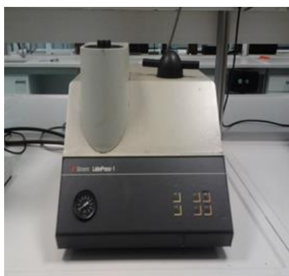
Εικόνα 3.4: Συσκευή εγκιβωτισμού της εταιρείας Struers-Labopress1
