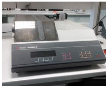
Εικόνα 3.3: Συσκευή υγρής κοπής της εταιρίας Struers / Acutom-5
