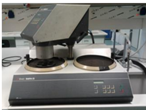
Εικόνα 3.5: Συσκευή λείανσης και στίλβωσης της εταιρίας Struers-Rotopol-25
