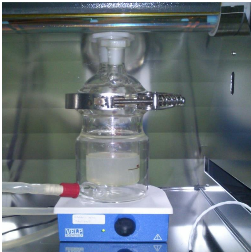
Εικόνα 8.3. Γυάλινος αντιδραστήρας Duran® glass με συνεχή ανακυκλοφορία νερού βρύσης στο εσωτερικό του προσομοιωτή ηλιακής ακτινοβολίας.
