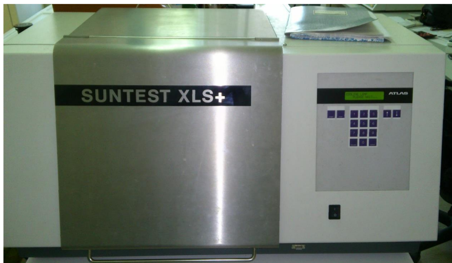
Εικόνα 8.2. Προσομοιωτής ηλιακής ακτινοβολίας SUNTEST XLS+ της εταιρείας Atlas.
