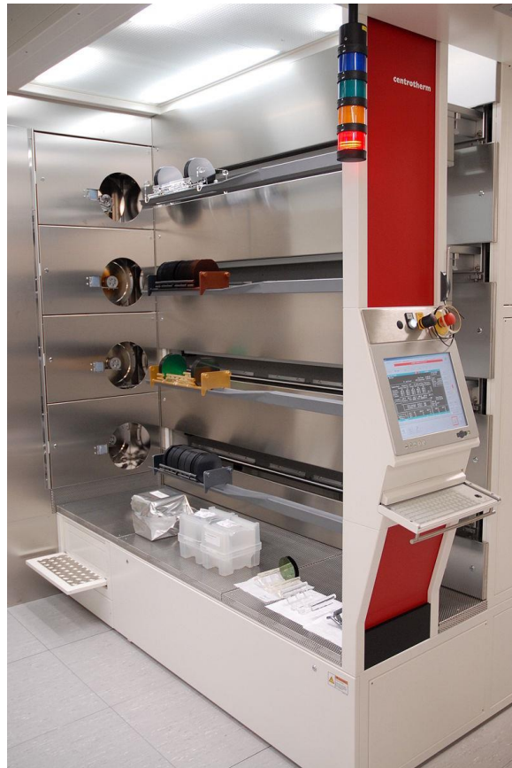
Εικόνα 4.4: Φούρνοι υψηλής θέρμανσης που χρησιμοποιούνται για διάχυση και θερμική οξείδωση. [46]
