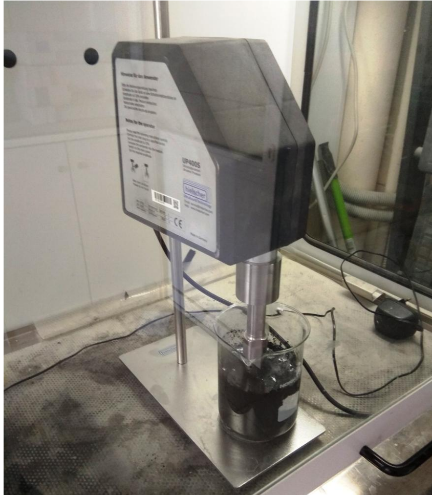
Εικόνα 5.3 Διαδικασία υπερήχησης με συσκευή Sonicator tip.
