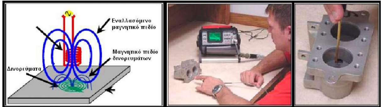
Εικόνα 4.4 Μέθοδος των δινορευμάτων.
