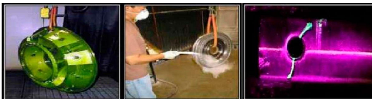
Εικόνα 4.2 Μέθοδος των διεισδυτικών υγρών.
