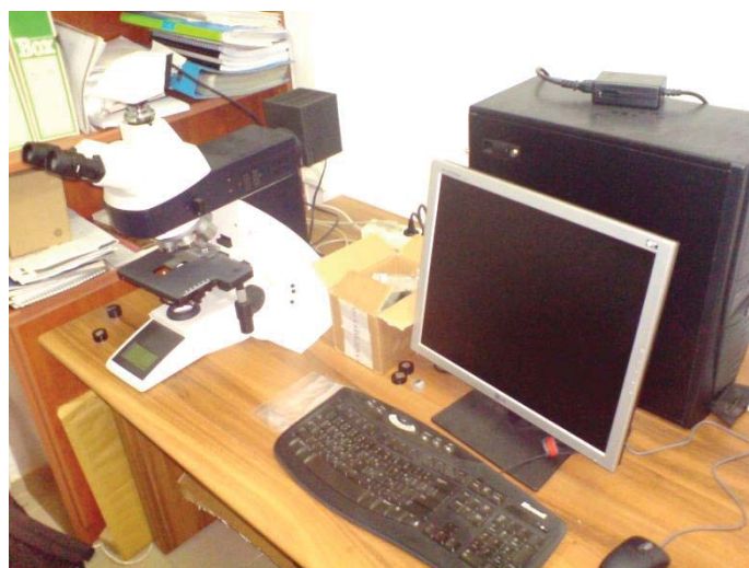
Εικόνα 4.6: Οπτικό μικροσκόπιο Leica DM-4000 διασυνδεδεμένο με ηλεκτρονικό υπολογιστή.
