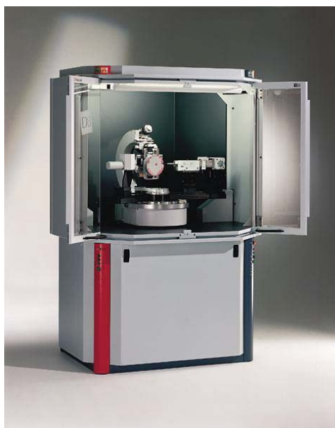
Εικόνα 4.5: Περιθλασίμετρο Bruker D8 στο οποίο έλαβαν χώρα οι μετρήσεις περίθλασης ακτίνων-Χ (οριζόντιο δίκτυο οργάνων, Πανεπιστήμιο Ιωαννίνων).
