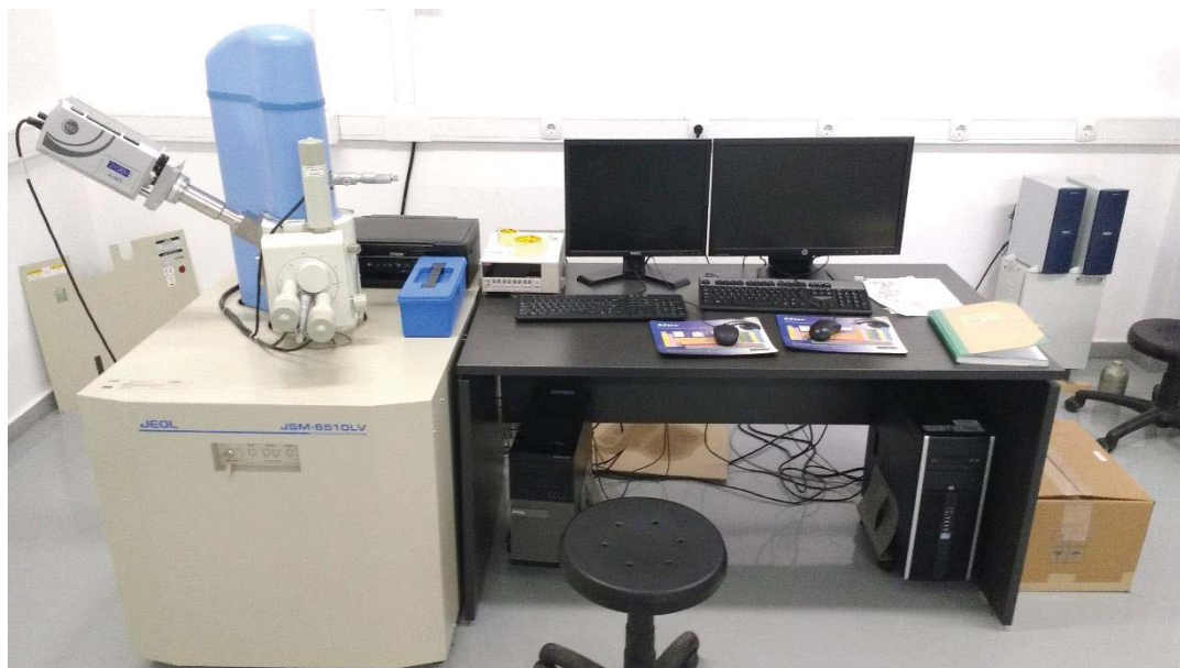
Εικόνα 4.7: Ηλεκτρονικό μικροσκόπιο σάρωσης Jeol JSM 6510 με σύστημα στοιχειακής μικρο-ανάλυσης ακτίνων-X (οριζόντιο δίκτυο οργάνων, Πανεπιστήμιο Ιωαννίνων).
