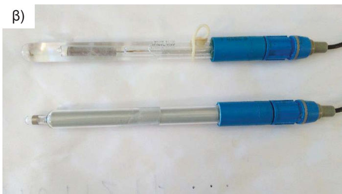
Εικόνα 4.9: Οργανολογία που χρησιμοποιήθηκε στα πειράματα ποτενσιοδυναμικής πόλωσης και χρονοαμπερομετρίας: α) γαλβανοστάτης/ ποτενσιοστάτης Gill AC της ACM Instruments, β) ηλεκτρόδιο αναφοράς (Ag/AgCl) και βοηθητικό ηλεκτρόδιο (Pt), γ) πείραμα κυκλικής ποτενσιοδυναμικής πόλωσης εν εξελίξει.
