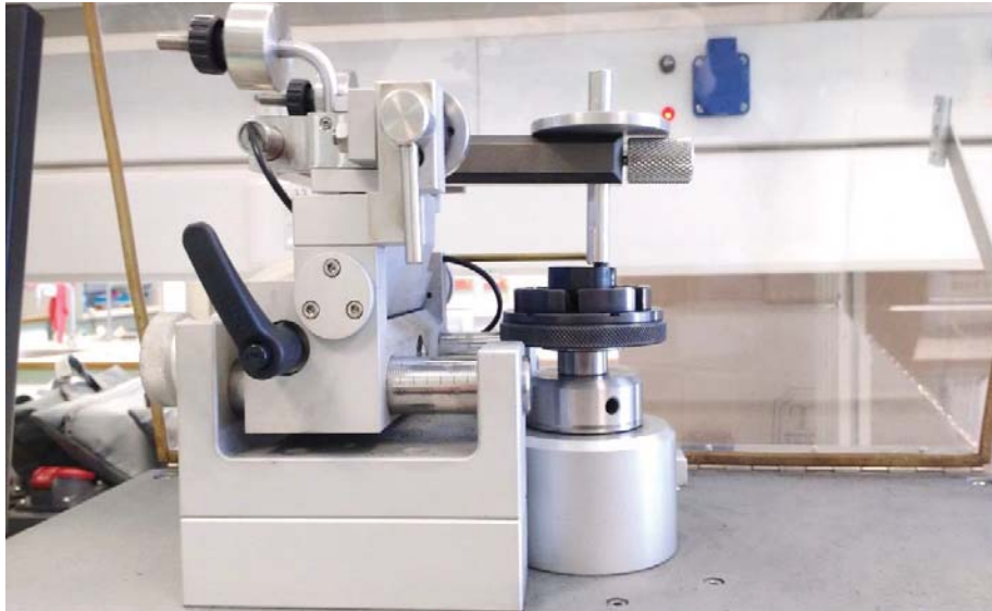
Εικόνα 4.10: Τριβόμετρο της CSM Instruments στο οποίο έλαβαν χώρα οι δοκιμές φθοράς ολίσθησης.
