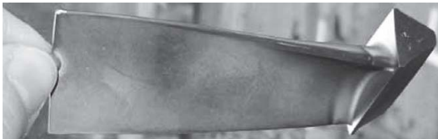
Εικόνα 1.1: Πτερύγιο από αεροστρόβιλο κινητήρα ελικοπτήρου όπου έχει εναποτεθεί επικάλυψη πάχους 0,3 mm του ΠΜΚ Al-Co-Fe-Cr [29].
