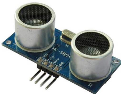
Σχήμα 2.16: Αισθητήρας Υπερήχων HC-SR04 (Πηγή: https://goo.gl/h3gmIP )
