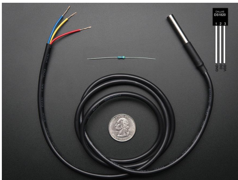
Σχήμα 2.12: Αδιάβροχος αισθητήρας θερμοκρασίας 1-wire DS18B20
