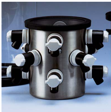
Σχήμα 6.2: Θάλαμος λυοφιλιοποίησης με 12 υποδοχές.
