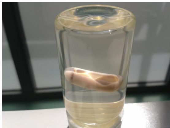
Εικόνα 32. Υδροπήκτωμα αλγινικού οξέος με πηγή ιόντων ζελατινοποίησης \text{CaCO}_3 , μετά από 24 ώρες.
