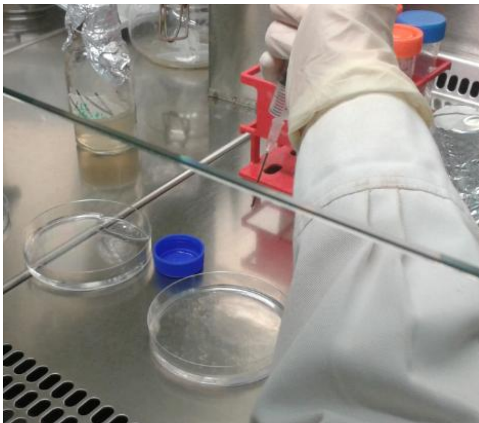
Εικόνα 77. Σχηματισμός σφαιριδίων αλγινικού πηκτώματος με εγκλωβισμένα κύτταρα.
