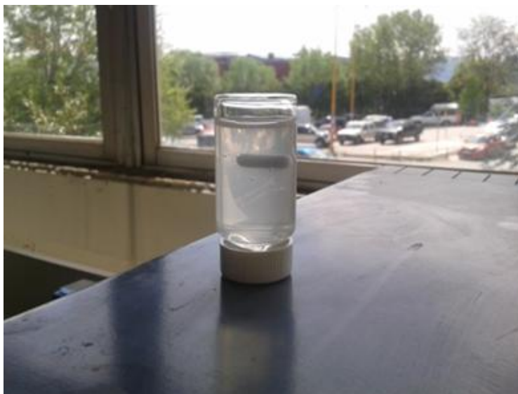
Εικόνα 29. Υδροπήκτωμα αλγινικού οξέος με πηγή ιόντων ζελατινοποίησης από \text{CaCl}_2 . Παρατηρείται η αργή καταβύθιση της μαγνητικής ράβδου λόγω του υψηλού ιξώδους του πηκτώματος.
