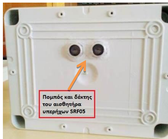
Σχίμα 51. Κάτω όψη του κουτιού του υποσυστήματος προσδιορισμού της στάθμης του ποταμού
