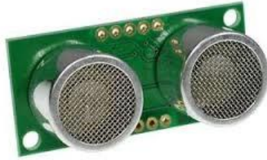
Σχήμα 20. Εμπρόσθια όψη του αισθητήρα υπερήχων SRF05 με τον πομπό και τον δέκτη
