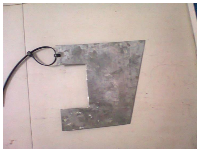
Σχήμα 29. Κατασκευή του πηδαλίου ευθυγράμμισης του αισθητήρα μέτρησης ταχύτητας νερού Vernier
