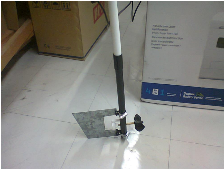
Σχήμα 30. Το ρόμετρο Vernier με προσαρμοσμένο το πηδάλιο ευθυγράμμισης
