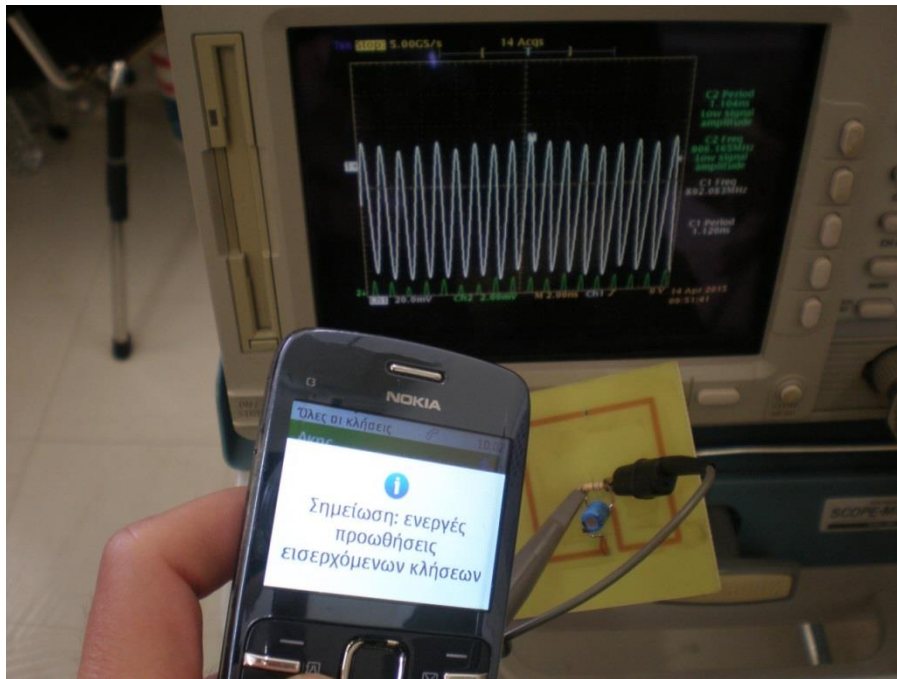
Σχήμα 74. Μετρήσεις απόδοσης κεραίας συλλογής ενέργειας μικροκυμάτων με τηλεφωνική κλήση
