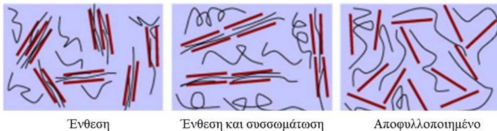
Εικόνα 2.4: Σχηματική αναπαράσταση τριών διαφορετικών θερμοδυναμικά δυνατών μορφών νανοσύνθετων πολυμερούς/φυλλόμορφου υλικού. [222]
