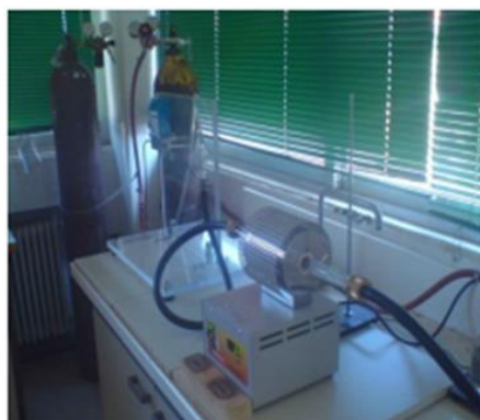
Εικόνα 3.14: Σωληνωτός φούρνος σε αδρανή ατμόσφαιρα (ροή αδρανούς αερίου N 2 ). [19]
