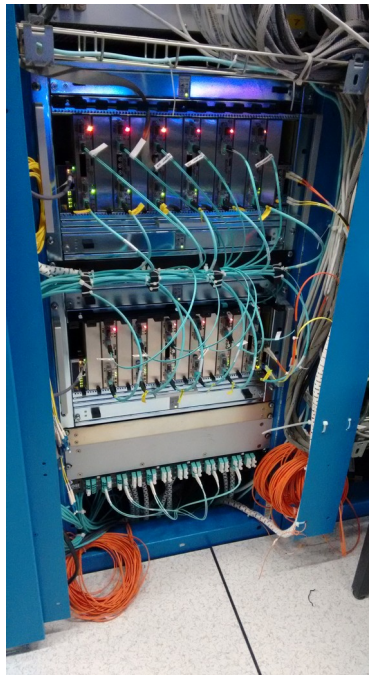
Εικόνα 42: Το σύστημα BMTF. 6 κάρτες στο άνω μέρος συνδέονται σε μια AMC13 και ομοίως στο κάτω μέρος.
