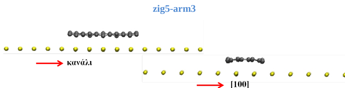
Σχήμα 4.3.2.2: αριστερή εικόνα: πλάγια όψη της νιφάδας zig5-arm3 πάνω στην Cu (110) κατά την διεύθυνση του καναλιού, δεξιά εικόνα: πλάγια όψη της νιφάδας zig5-arm3 πάνω στην Cu (110) κατά την διεύθυνση [100] της επιφάνειας της Cu (110).
