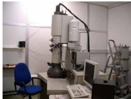
Σχήμα 3.1.5: Ηλεκτρονικό μικροσκόπιο διέλευσης και φωτογραφία ενός Philips CM20 TEM με ultrathin window energy dispersive X-ray (EDX) analyzer και Gatan imaging filter (GIF200) για μικροανάλυση με electron energy loss spectroscopy (EELS) .
