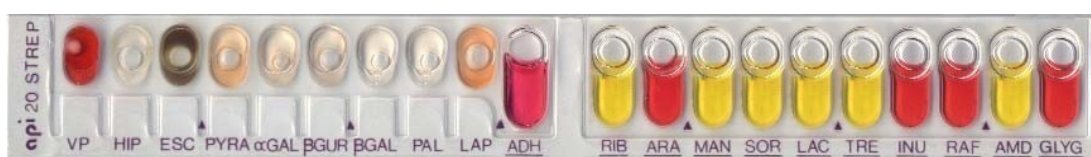
Εικόνα Β.16. api 20 STREP με θετικές τις αντιδράσεις των VP, ESC, PYRA, LAP, ADH, RIB, MAN, SOR LAC, TRE και AMD.
